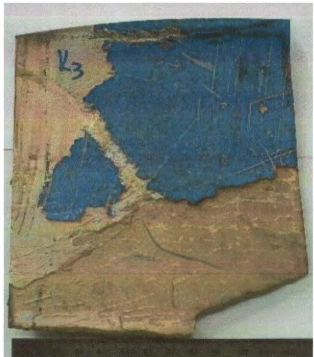
Εικόνα 41: Δείγμα "K3" (Κόκπιτ) από το εμπρόσθιο τμήμα του Θαλάμου Μηχανοδήγησης, με το λογότυπο της εταιρείας και τον αριθμό της Ηλεκτρομηχανής (120 012)
