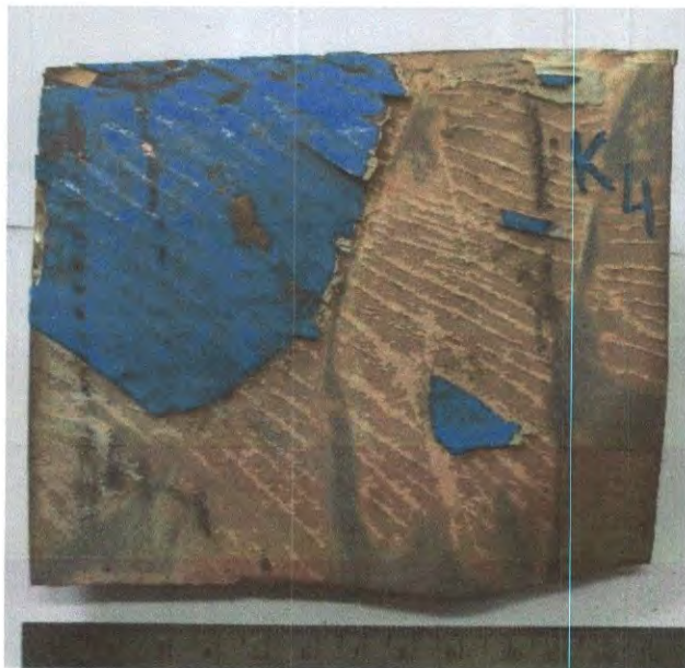
Εικόνα 55: Δείγμα "Κ4" (Κόκπιτ 4) από το πάνω τμήμα της βάσης-προφυλακτήρα του Θαλάμου Μηχανοδήγησης
